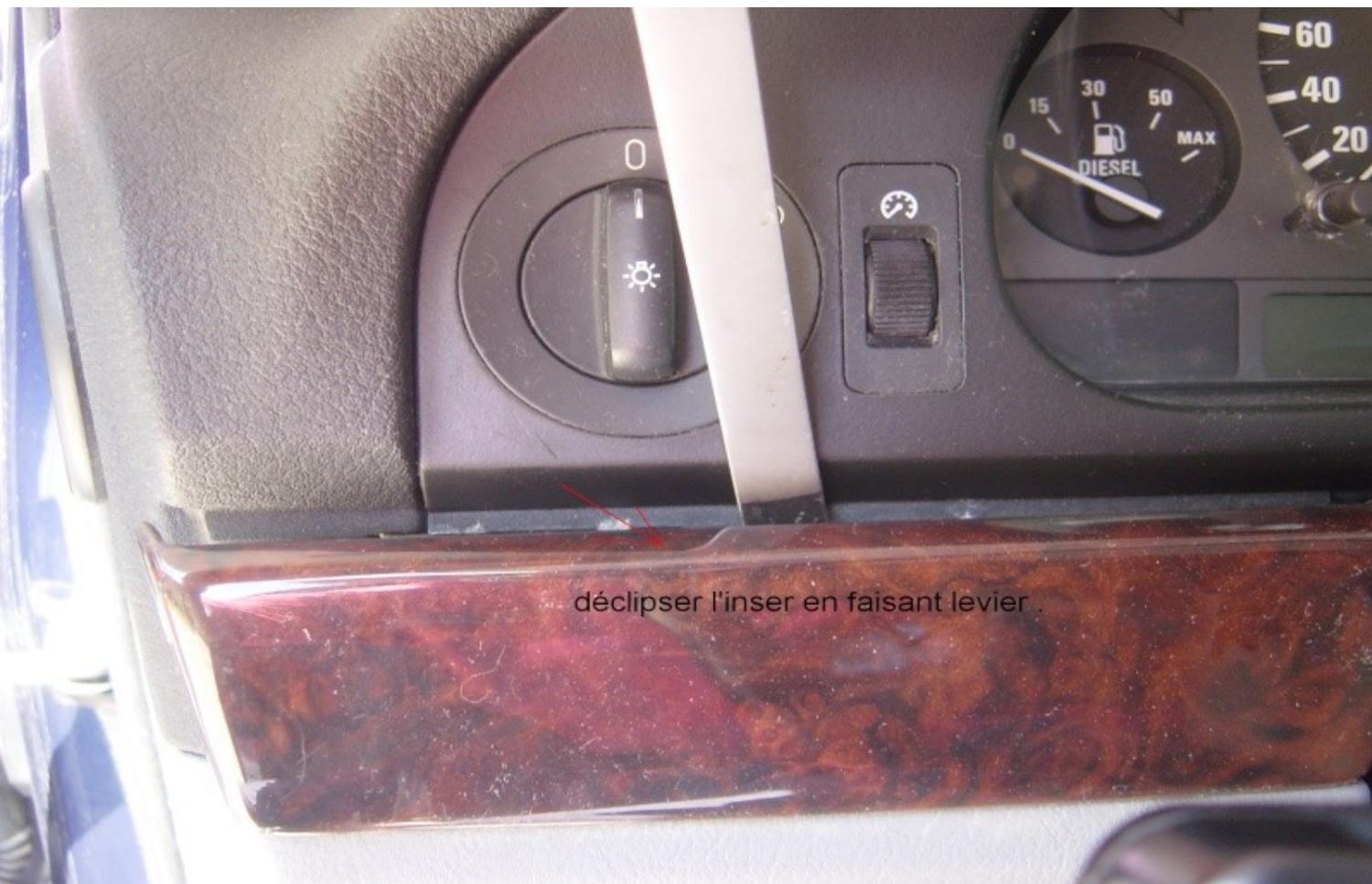
déclipser l'insér en faisant levier .
